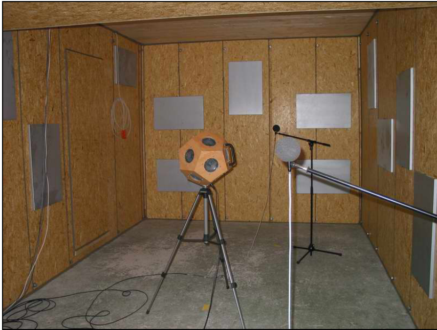
Abbildung 88 Reflektoren an den ER-Wänden
